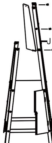
Paso 3: Conecte el marco de soporte central 4 X (I), el marco de soporte inferior, el panel inferior y la puerta utilizando tornillos 8 X (BB) y tuercas 8 X (DD), por favor, tenga en cuenta que estos pernos y tuercas están pre-montados en el paso 1.
